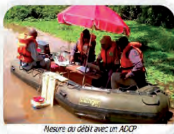
Mesure du débit avec un ADCP
